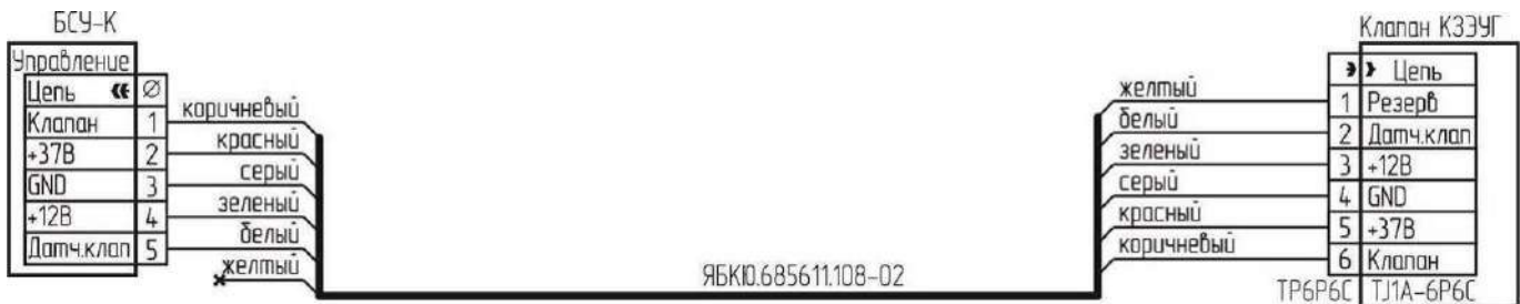
Рисунок Г.7 – Типовая схема подключения клапана К3ЭУГ с разъемом TJ1A-6P6C
