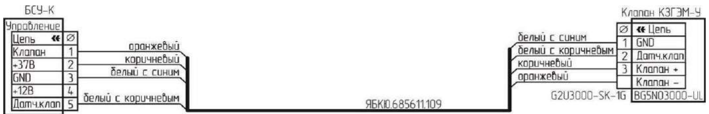
Рисунок Г.6 – Типовая схема подключения клапана К3ГЭМ-У с разъемом BG5N03000-UL
